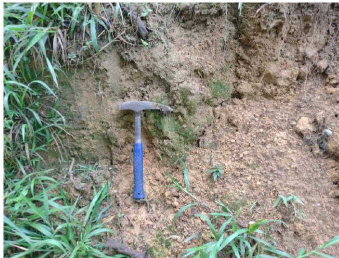
Figura 115. Depósitos de flujo de lodo y escombros, localizados en la vereda La Chuscala. Fuente: Estudio básico de amenazas Caldas (2021)
